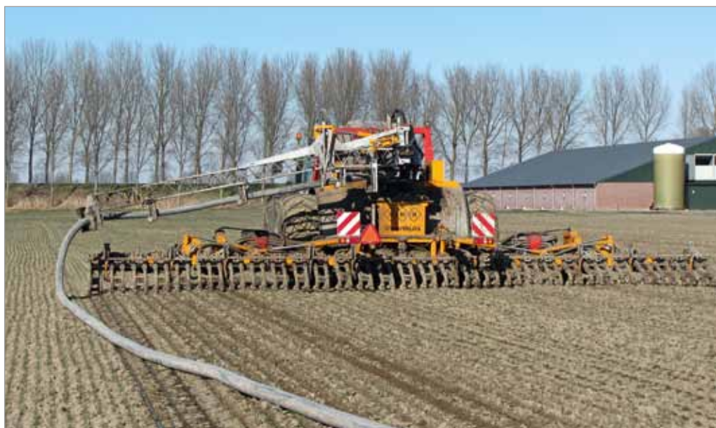
Благодаря тому что в системах с самоподтягивающейся катушкой буксировка шланга не производится, они могут с успехом применяться не только до посева, но и даже по стеблестую.
