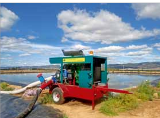
Производительность наиболее мощных насосных станций с интегрированными двигателями может достигать 300 м 3 /ч.
